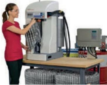
**Complete:** Crea tubos de espuma continua (CFT) y bolsas rellenas de espuma usando compuestos de alto rendimiento. Su diseño compacto, programa personalizado y acumulación just-in-time hacen que el sistema se adapte perfectamente a operaciones de embalaje de cualquier tamaño.
